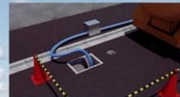
回収車への配管接続イメージ
