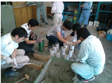
試験体製作状況
