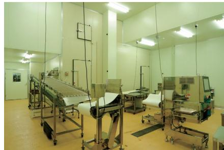
【工場のクリーンルーム化】●人に付着した塵埃等の汚染物質を工場内部に持ち込ませないようにする為、清浄空気で吹きかけ洗浄するエアシャワー設備を設置しています。●製造する食品の品質確保の為、赤(汚染区)・緑(中間区)・黄(清浄区)と衛生区域を識別できるように床色分けを採用しています。●製造ラインの室圧管理を行い、菌や虫など混入されない環境を作っています。
